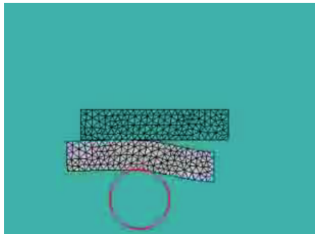
図 3: 線形弾性体と剛体円の接触解析例
